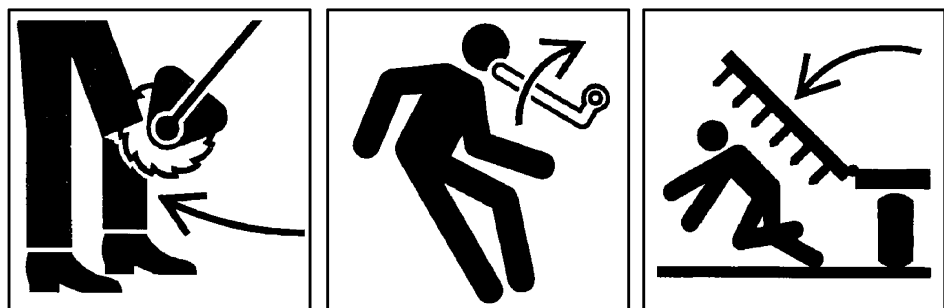
图 D.21 使用表示机器部件运动方向的箭头的图形示例
